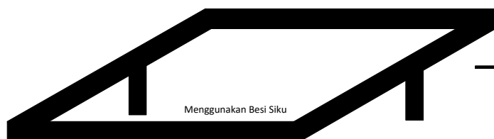
Gambar 3. Rangka Dudukan Solar Panel
